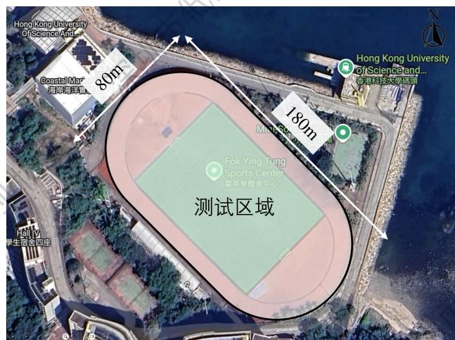
实验设施布置于场地中心的人造草足球场上，草坪尺寸为 100m×63m。由 15 个地面传声器组成的传声器阵列布置于场地中央并与短边平行，传声器沿西南至东北方向编号为#1 至#15，#8 位于场地中心（O 点）。一台便携式气象站布置于场地南侧，持续采集测试时段内的气象数据，包括风速、风向、温度、湿度及压强等。
